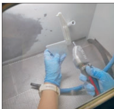
Säubern mit Pressluft
